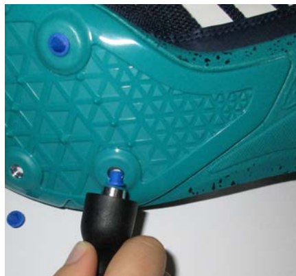
Einbau der Kunststoff-Spikedornen
