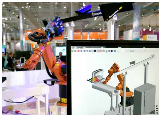
CeramSolutions 4.0 erfasst die Objektgeometrie und führt den Glasurprozess vollautomatisch durch
