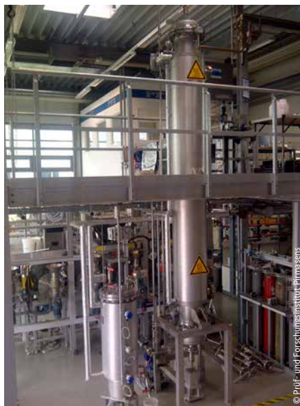
Rieselstromreaktor zur reststoffbasierten Bio-butanol-Produktion im Technikum des PFI
