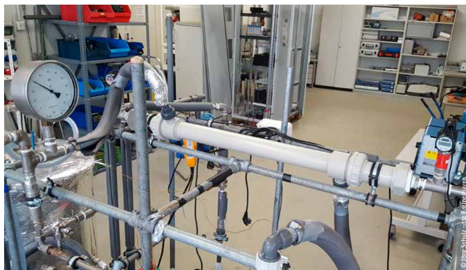
Tubular Flow-Modul im experimentellen Versuchsaufbau einer Membrandestillation
