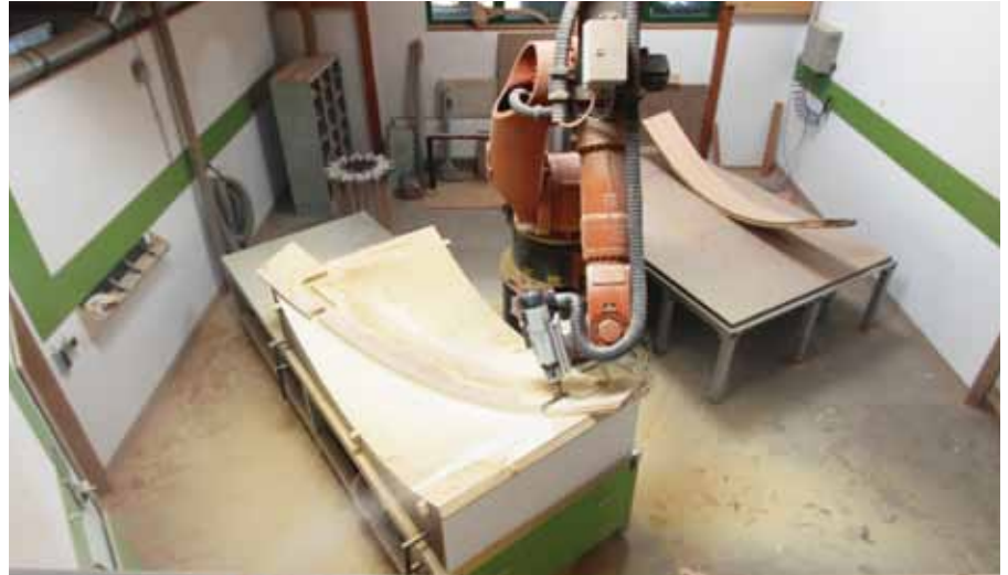
Anordnung des CNC-Fräse Roboters und Arbeitstisch mit Werkstück
