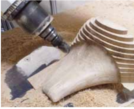
Mehrzeitiges Abtragen und anschließende Feinfräsung des Werkstücks
