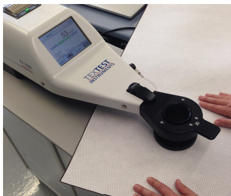
Das neue Luftdurchlässigkeits-Prüfgerät FX 3300-IV ist sehr vielseitig einsetzbar und einfach zu bedienen
