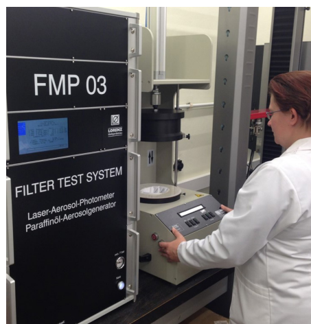
Mithilfe des neuen Messgeräts FMP03 wurden bereits verschiedene Materialien hinsichtlich Arosoldurchlässigkeit getestet und ersten Erfahrungen gesammelt.
